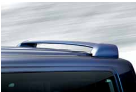
CR01058 Dachspoiler PU-RIM, lackierfähig, nicht in Verbindung mit Dachgrundträger. Nur Export, kein TÜV-Gutachten
