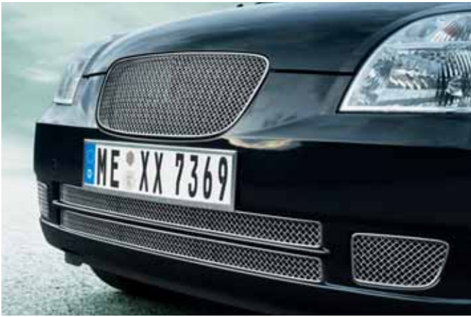
VM01560 Stoßstangengrill für Frontstoßstange, Edelstahl verchromt, oben VM01561 Stoßstangengrill für Frontstoßstange, 2-teilig, Edelstahl verchromt, unten VM01546 Nebellampengitter 2-teilig, Edelstahl verchromt
