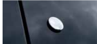
MS01342 Abdeckung für Heckscheibenhalterung Edelstahl verchromt, Satz
