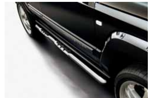
AN01465 Seitenschwellerrohre Edelstahl poliert, 60 mm, mit Noppen-Auftritt, Satz
