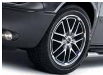
Art. CW01486/GP LM-Felge Design XA, 8,5 x 19", ET 35 mm, LK 5/114,3 mm, Mittenloch 71,5 mm, graphit-poliert, Abb. ähnlich
